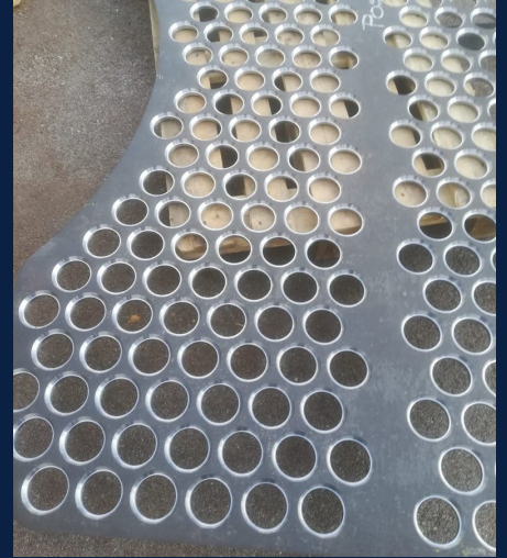
Delinmiş boru aynası
