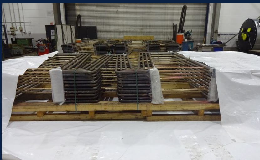
Serpentins de surchauffeur
