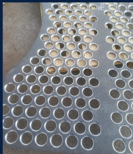
Placa tubular perforada
