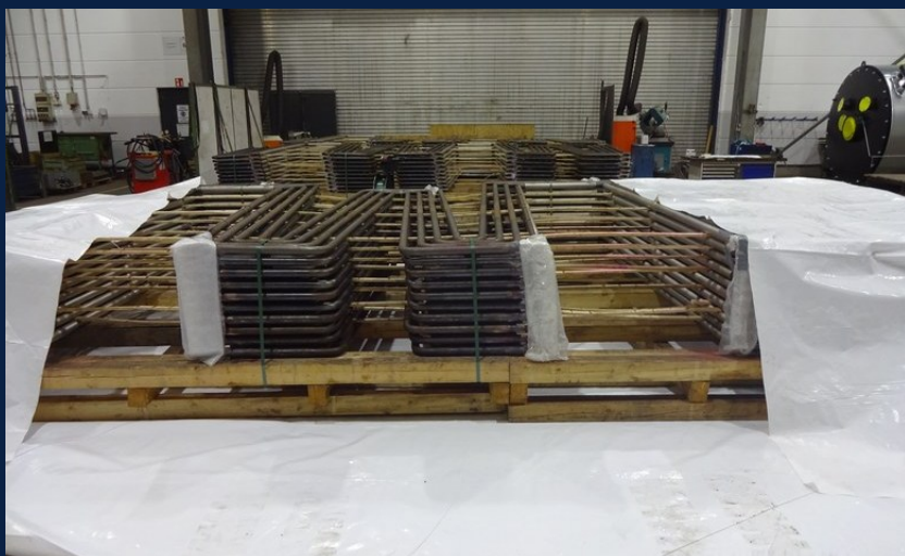
Serpentines de sobrecalentador
